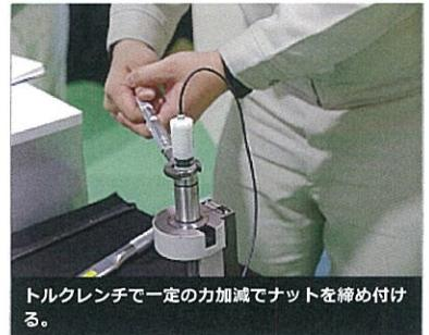
トルクレンチで一定の力加減でナットを締め付ける。
