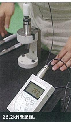
動的振れ精度（回転中の振れ精度）が高いということは、工具摩耗が少なくて済むということ。つまり1本の加工個数が増えるのだ。スーパーG1チャックへ切り替えたユーザーからは、「以前よりも工具が長持ちするようになった」という声が多いとのこと。そして、工具が長持ちすることで、工具交換の回数が減り、段取り時間の短縮につながるというわけである。
