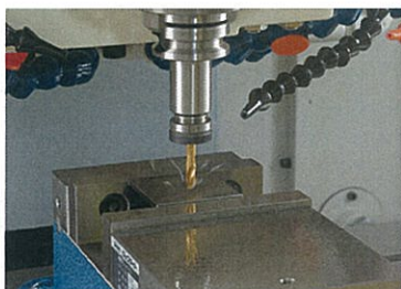
スーパーG1チャックは総合振れ精度表記で振れ精度を保証している
